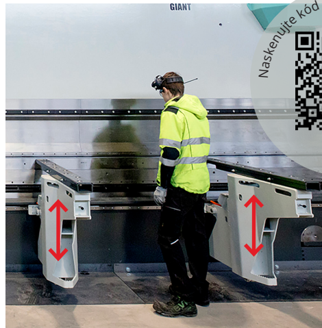
Vertikální nastavení odlehčeno plynovým válcem
