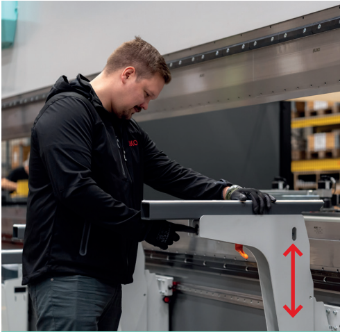
Vertikale Verstellung erleichtert durch Gasdruckzylinder
