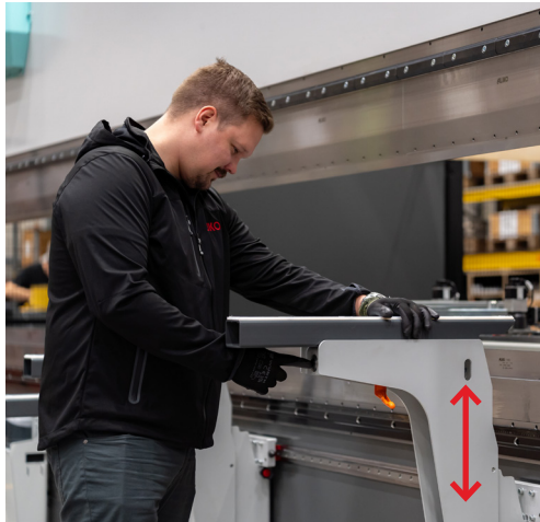
Vertikal justering avlastad med gasfjäder
