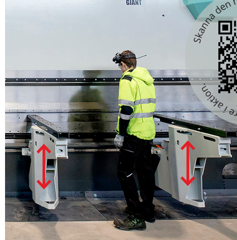
Vertikal justering avlastad med gasfjäder
