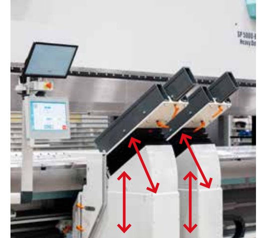
Beweging via CNC-gestuurde elektrische cilinders, geen handmatige instelling nodig
