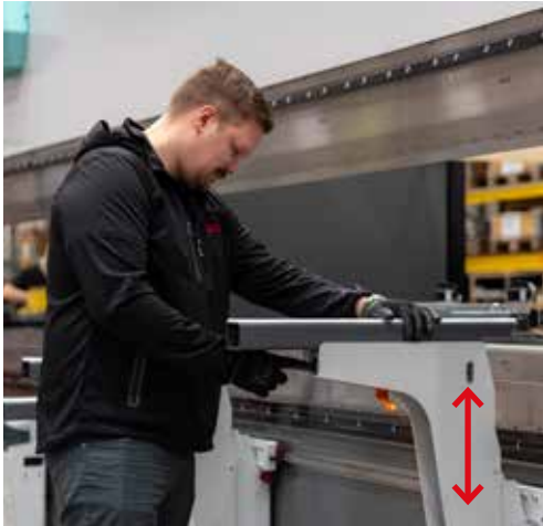
Soepele zijwaartse verplaatsing met lineaire geleidingen
